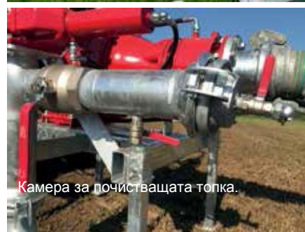
Камера за почистващата топка с/в 3/4". Ръчен сферичен кран & връзка към компресора
