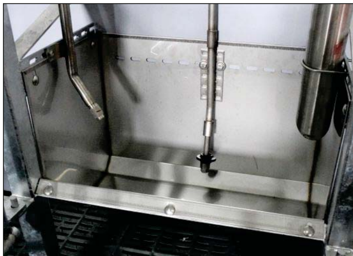
Право корито в бокс за опрасване и кърмене със система за хранене Gestal Solo
